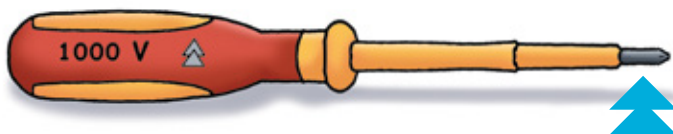
TOURNEVIS ISOLÉ APPROUVÉ POUR 1000 V.
