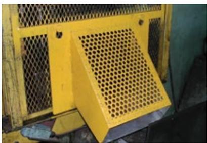
Protecteur muni d'une ouverture pour la sortie des pièces
