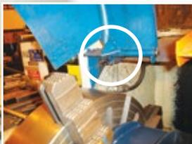
Un dispositif de protection commande l'arrêt de la machine dès l'ouverture du protecteur.
