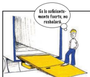
Un puente bien ajustado apoyado en el muelle y en el remolque
