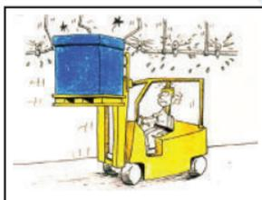
Rotura del conducto de rociadores al levantar una carga
