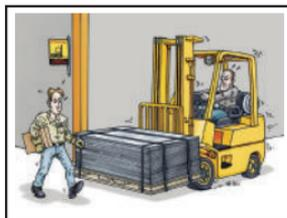
Sujetar la carga de forma segura e inclinar el mástil
