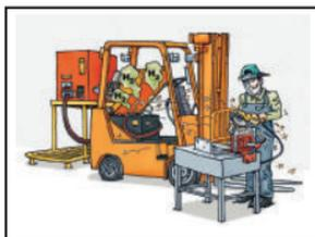
Peligro de explosión debido al hidrógeno que se libera al recargar las baterías
