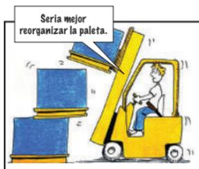
Reposicionar la carga antes de depositar otra
