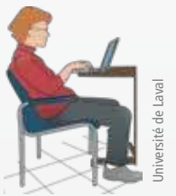
Portable placé sur la table pour travailler avec la tête droite, mais poignets, bras et dos se retrouvent dans une posture inconfortable.
