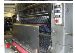
Angles rentrants entre les rouleaux encres et les rouleaux de mouillage
