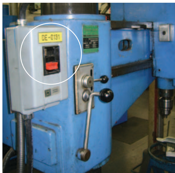
Exemples de dispositifs d'isolement : sectionneurs électriques et valve pneumatique
