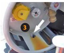
6. Ouvrir lentement le robinet d'alimentation et vérifier l'absence de fuite (sentir, écouter, regarder). Une méthode recommandée pour détecter les petites fuites est de mouiller les raccords d'une solution savonneuse; la formation de bulles savonneuses signale la présence de fuites. En présence de fuites, le chariot doit être mis hors service jusqu'à ce qu'elles aient été colmatées.
