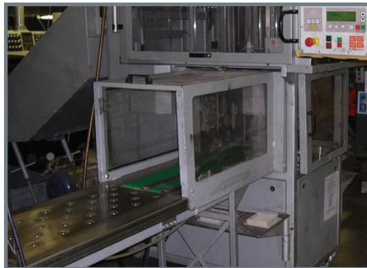
L'accès au plateau tournant côté sortie est protégé par un protecteur tunnel.
