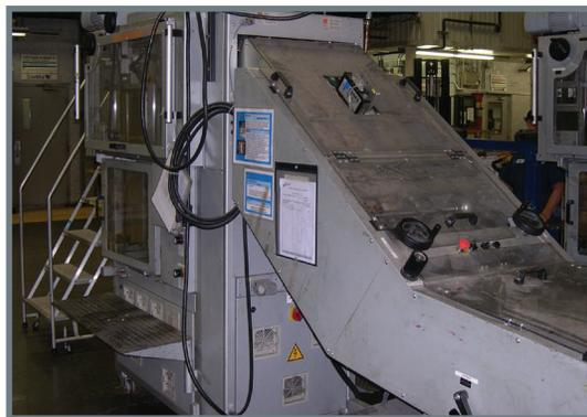
Les courroies du convoyeur d'alimentation sont protégées.
