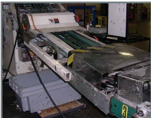
Les courroies du convoyeur d'alimentation ne sont pas protégées.
