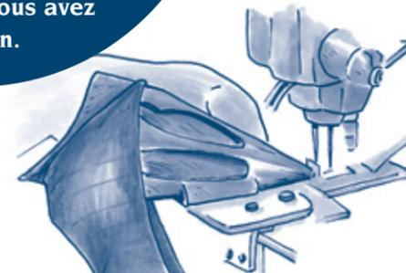
**petit truc** Souder le chasse-doigts plutôt que le visser constitue souvent une solution. On le soude sur la patte gauche du pied-presseur, car l'ourleur est fixé sur celle de droite.
