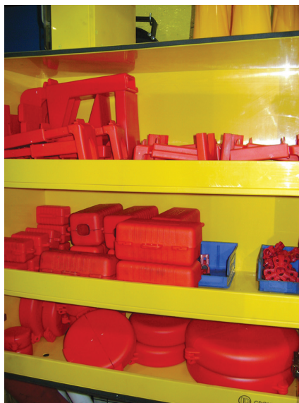
ACCESSOIRES POUR CADENASSER LES VALVES, LES FICHES, LES DISJONCTEURS, ETC.
