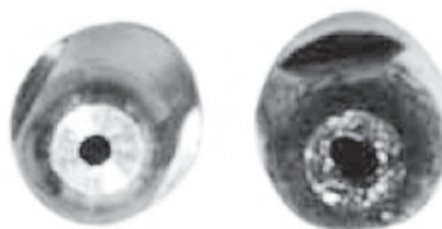
Tube contact en bon état et tube contact endommagé
