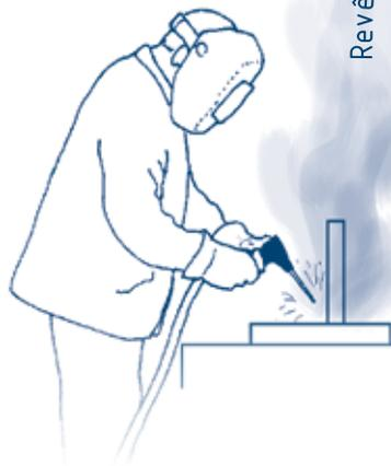
Le terme « soudage à l'arc » définit un procédé de soudage qui utilise l'arc électrique pour élever la température des métaux jusqu'au point de fusion. L'arc électrique se forme sous l'effet d'un courant qui traverse l'air entre la pointe de l'électrode et la pièce à souder. Selon le procédé, un flux ou un gaz de protection est utilisé pour protéger le bain de fusion de l'air ambiant. Ces différents procédés à l'arc (GMAW, FCAW, etc.) génèrent des fumées.
