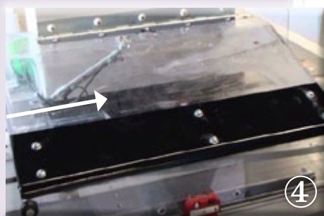
Reliure du document par un système de pression activé par une pédale.
