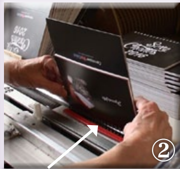
Insertion du document perforé sur un peigne de métal à demi ouvert.
